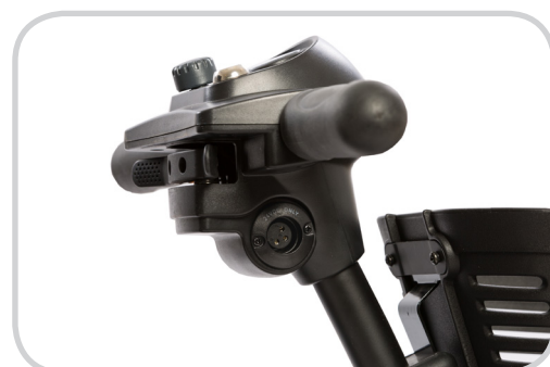
Handige plaatsing van de laadaansluiting boven in het stuur
