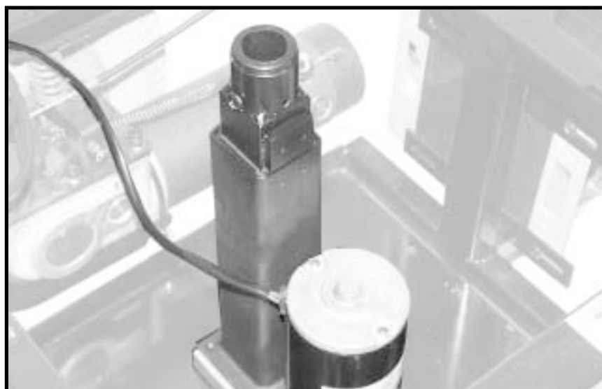
Figure 22. Servomoteur du siège électrique
