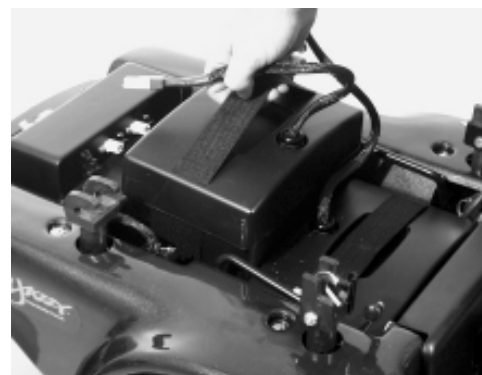
Figure 42. Enlèvement de Batteries
