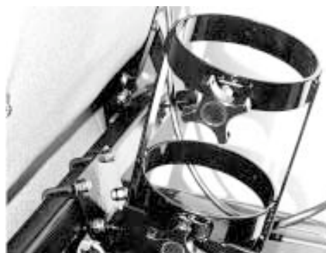
Figure 22. Support réservoir oxygène
