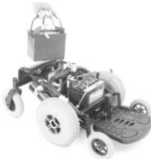
Figure 20. Enlèvement des batteries du Jet 3
