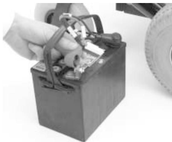
Figure 22. Branchement des câbles aux bornes des batteries
