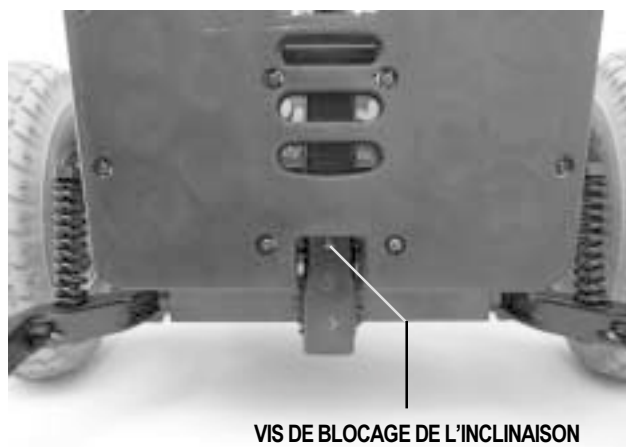
Figure 13. Réglage de l'inclinaison du repose-pied
