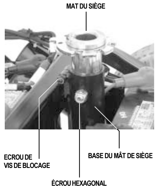
Figure 8. Réglage hauteur du siège
