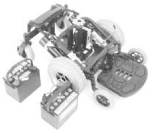
Figure 21. Batteries retirées du Jet 3
