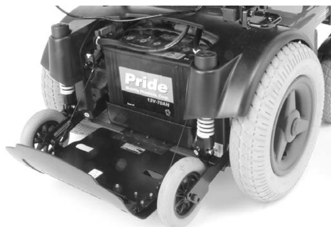
Fig. 6. Porte d'accès aux batteries abaissée
