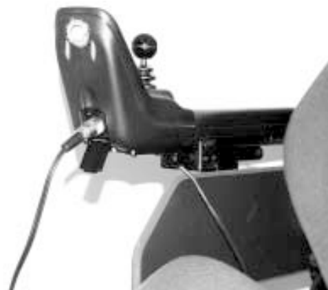
FIGURE 20. BRANCHEMENT DU CHARGEUR
