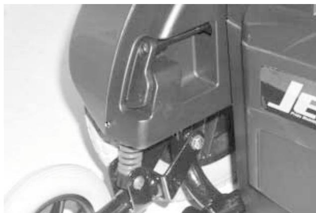
**Figure 10. Moteur en mode roue libre (neutre)**
