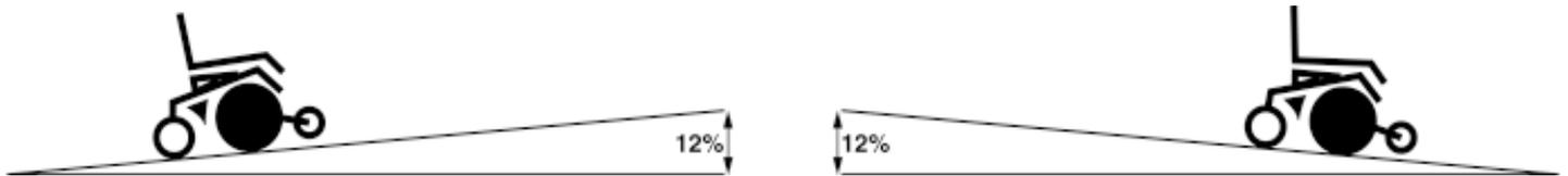
Figure 2. Inclinaison sécuritaire maximale
