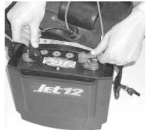
Figure 7. Retrait des couvercles des bornes
