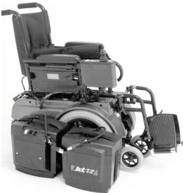
Figure 11. Jet 12 - Démonté et replié
