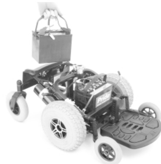
Figure 6. Enlèvement des batteries
