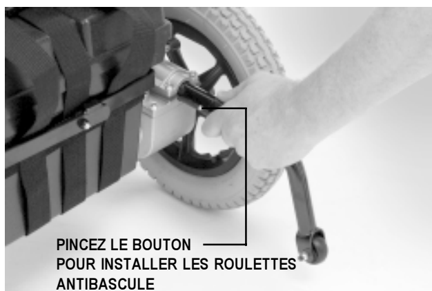
Figure 9. Installation des roulettes antibasculé
