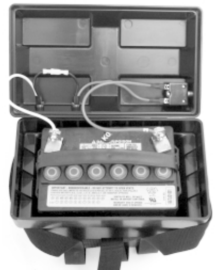
Figure 16. Installation d'une batterie
