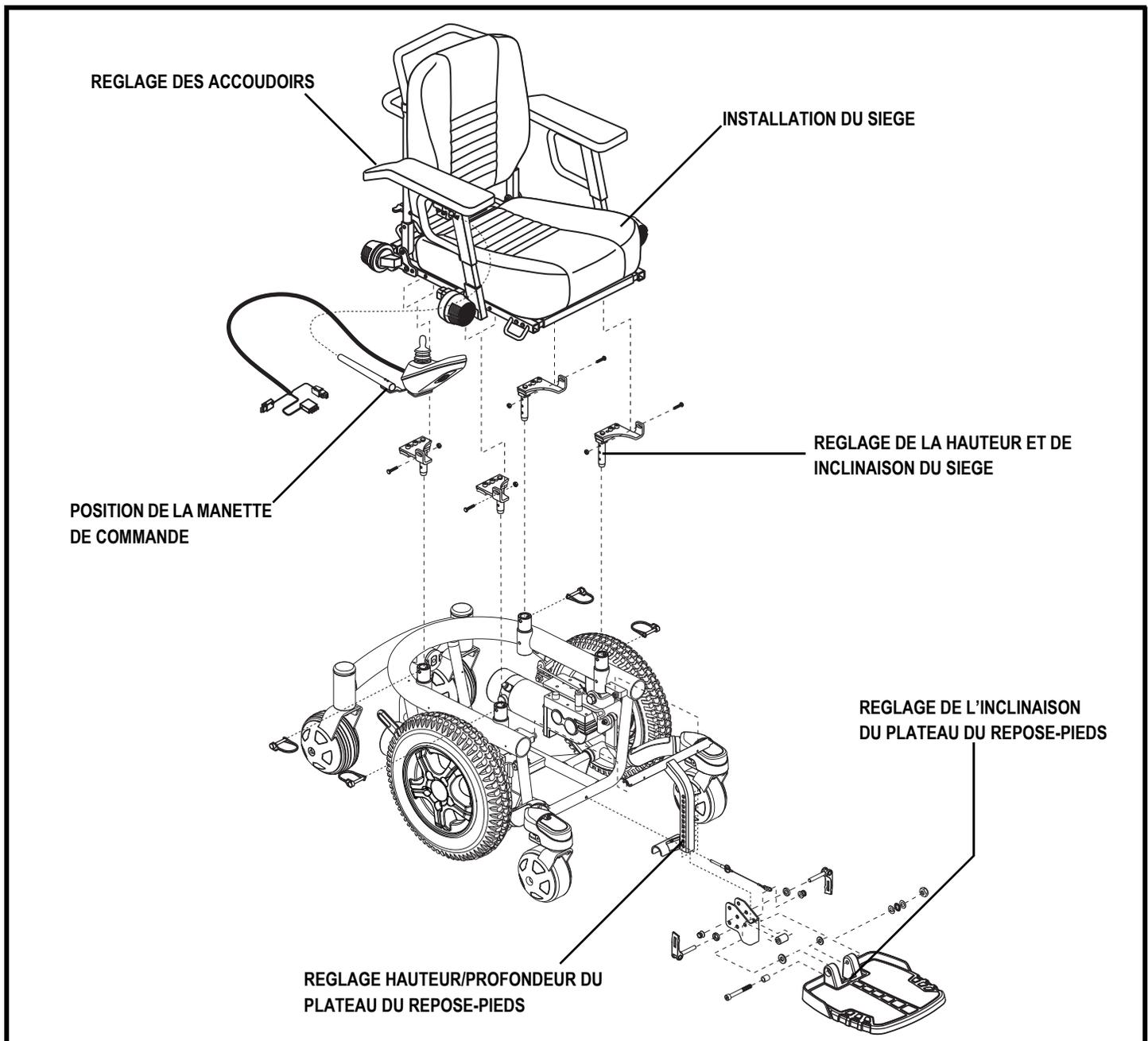
Figure 10. Vue de l'assemblage du fauteuil Quantum 600 (Euro Seat montré)
