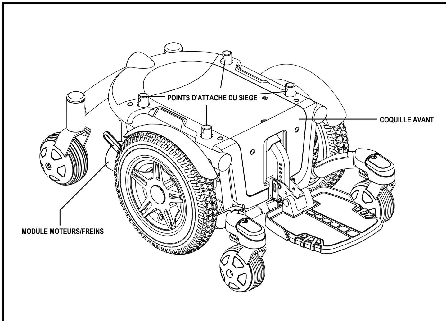
Figure 6. Base motorisée de Quantum 600
