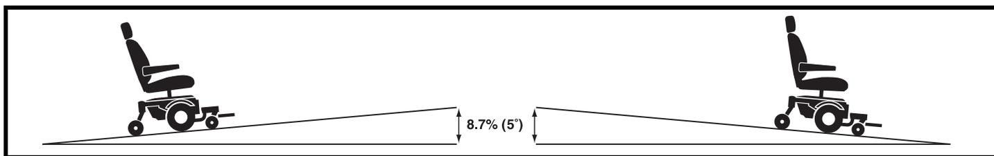
Figure 1. Montée/descente maximale
