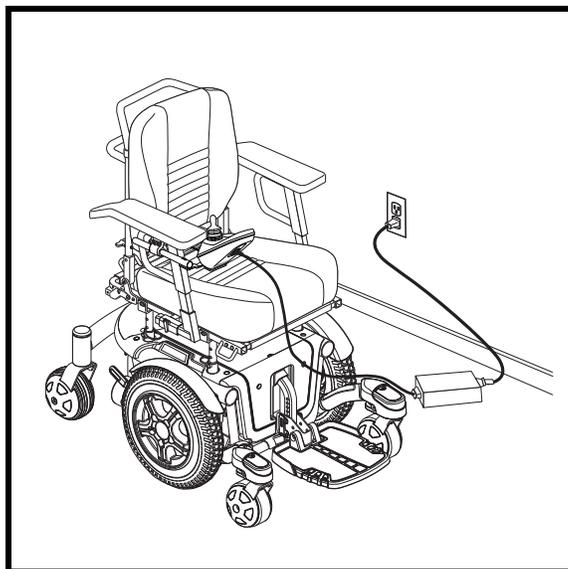
Figure 30. Batteries en recharge
