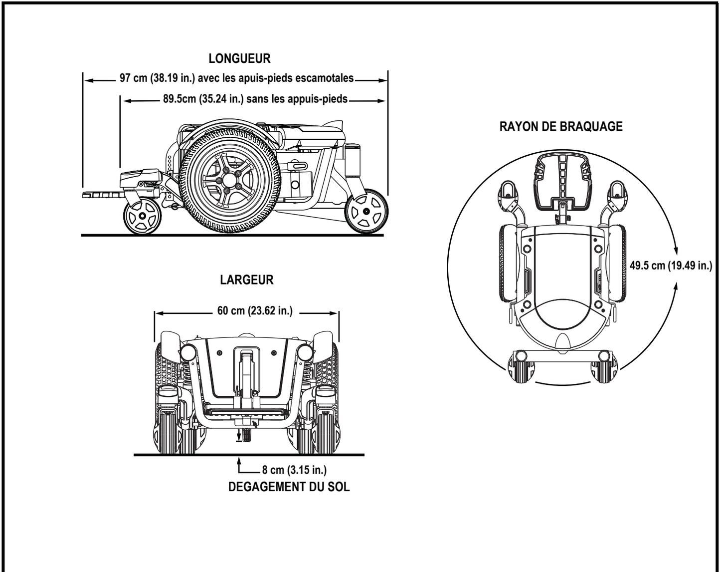
Figure 34. Quantum 600 dimensions et dégagement au sol
