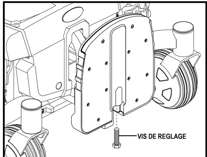
Figure 24. Réglage de l'angle du repose-pieds
