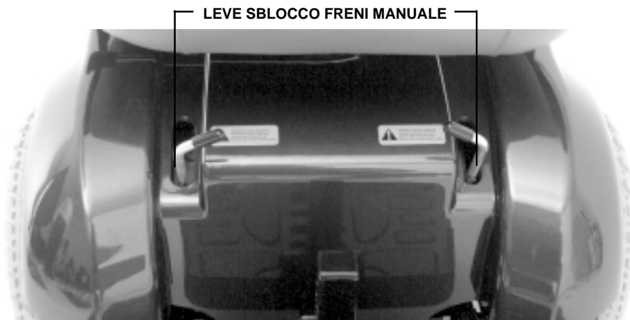
Figura 9. Motori disinnescati (modalità sblocco freni manuale)
