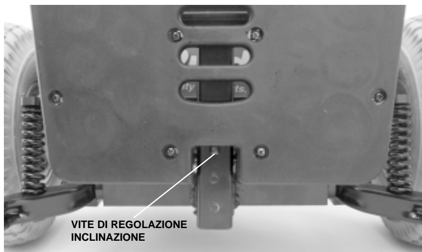
Figura 16. Regolazione inclinazione della pedalina
