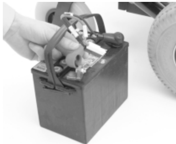
Figura 7. Connessione cavi ai terminali batteria
