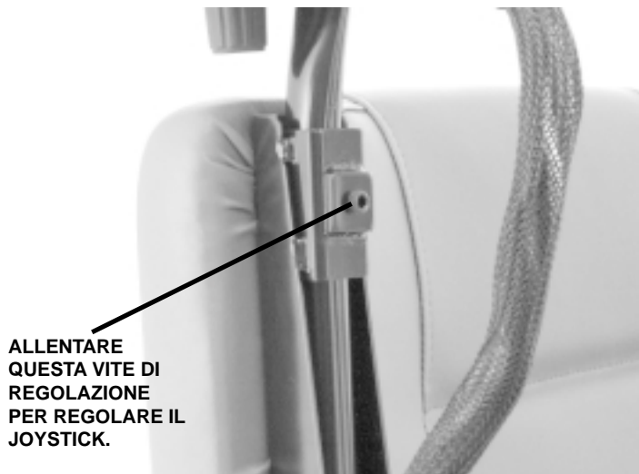
Figura 14. Distanza del joystick/centralina di controllo
