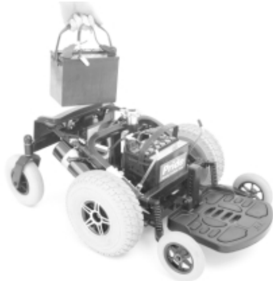
Figura 6. Rimozione batterie Jet 3
