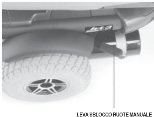
Figura 8. Modalità di sblocco ruote (Trazione disattivata)
