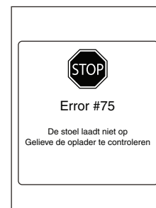
Figuur 18. Q-Logic 3 indicator voor het opladen van de batterij
