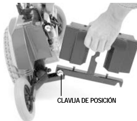
Figura 21. Conexión de la estructura frontal
