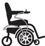
**Utilice los puntos de sujeción correctos para que los cables del regulador no queden atrapados en las ruedas motrices, pinzados en la estructura del asiento o se dañen al pasar por una puerta.**
