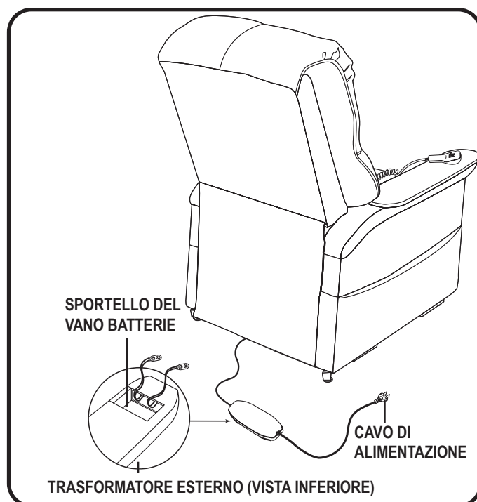
Figure 4.2 Ubicazione delle batterie di back-up della sollevatore poltrona
