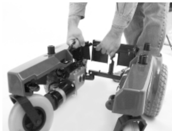
Figure 26. Alignement des éléments de structure.
