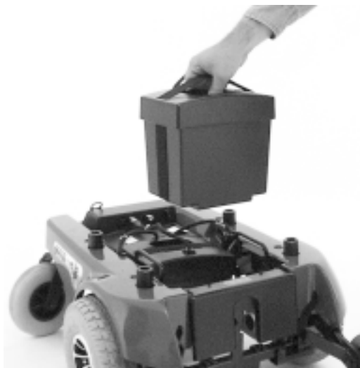
Figure 21. Retrait des boîtiers à batteries
