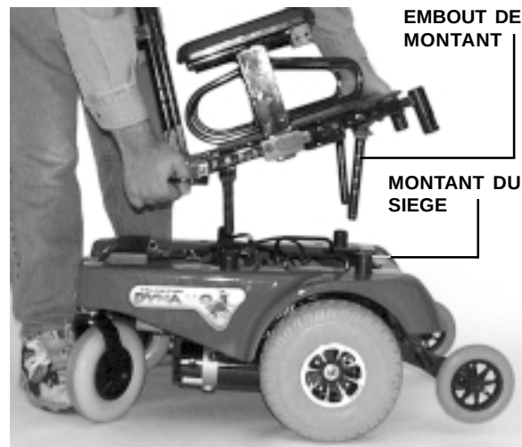
Figure 19. Enlèvement du "Versa Seat"
