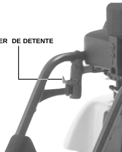
Figure 20. Enlèvement des repose-pieds
