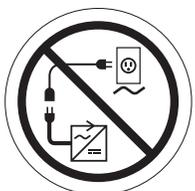
**N'utilisez pas de cordon de rallonge électrique pour brancher le cordon d'alimentation du chargeur à batteries.**
