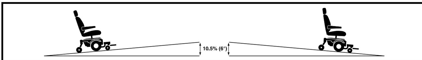
Figure 1. Montée/Descente maximale
