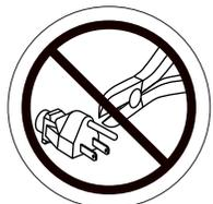
**Il est dangereux d'enlever la fiche de mise à la terre du cordon d'alimentation. Au besoin, faites installer une prise murale à 3 fentes ou utilisez un adaptateur à 3 fiches approuvé.**
