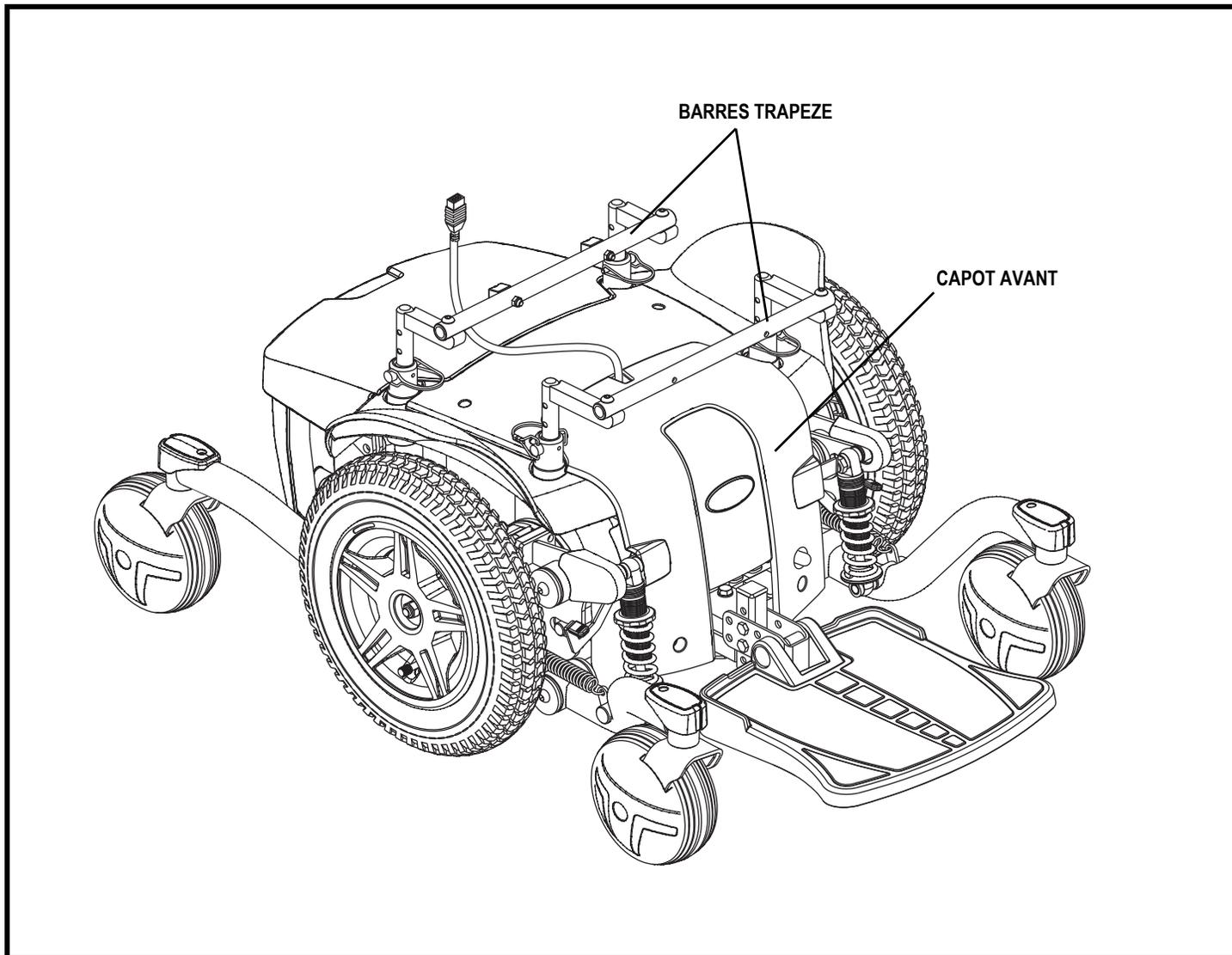
Figure 6. Base motorisée du Quantum 614
