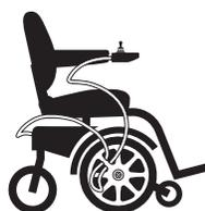
**Attachez correctement le câble du contrôleur afin d'éviter que celui-ci ne se coince dans les roues, dans le cadre du siège ou qu'il ne s'accroche lorsque vous passez le cadre d'une porte.**
