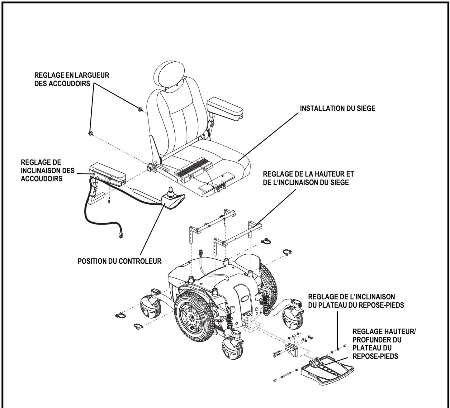
Figure 10. Vue de l'assemblage du fauteuil Quantum 614 (Système de siège standard montré)
