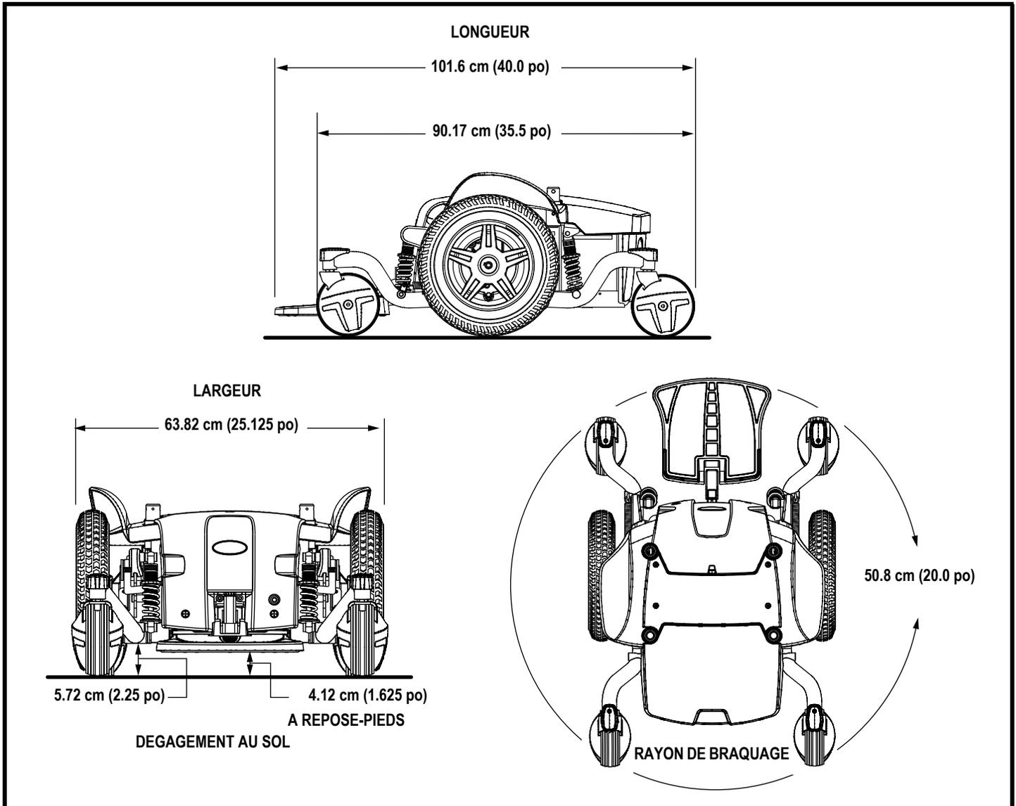
Figure 24. Dimensions et dégagement au sol Quantum 614
