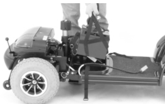
Figure 22. Enlevement des batteries
