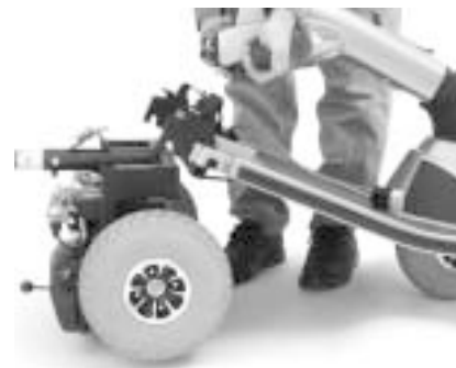
Figure 20. Séparation des sections du cadre
