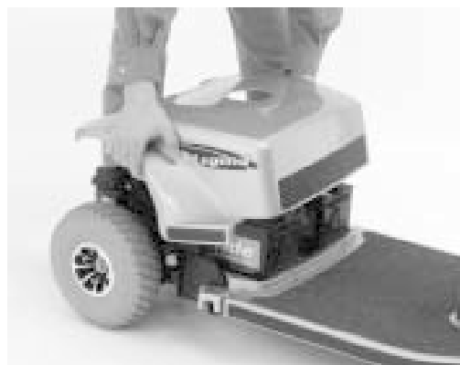
Figure 14. Enlèvement du capot
