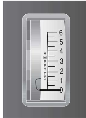
Figure 9. Ampèremètre (batteries complètement chargées)
