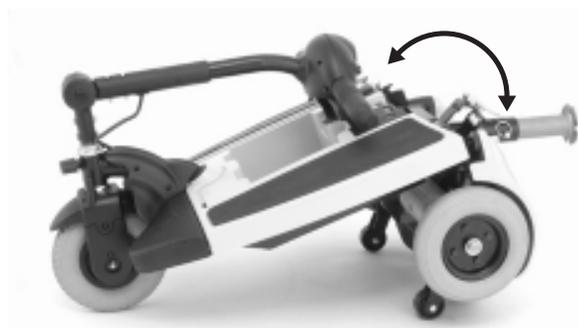
Figure 20. Positionnement du cadre
