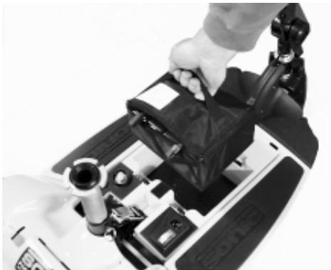
Figure 11A. Enlèvement du module de batteries
