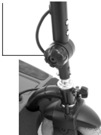
Figure 12. Réglage du guidon
