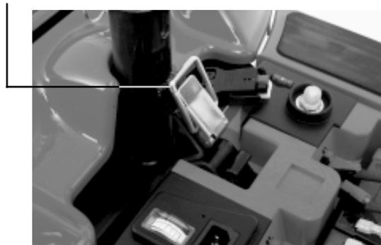
Figure 19. Fermoir à bascule
