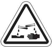
Les batteries contiennent des produits corrosifs. N'utilisez que des batteries scellées de type "AGM" ou des batteries au gel afin de réduire les risques de fuites ou d'explosions.
