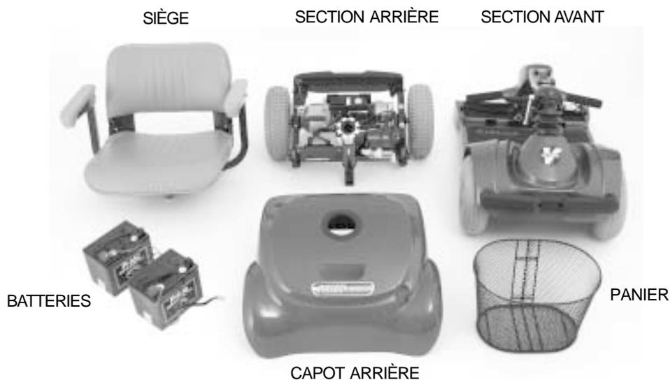
Figure 6. Sept Composantes Du Scooter Démonté
