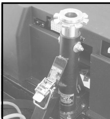
Figuur 16A. Dwarspen (niet verbonden)
