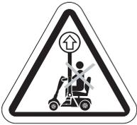
**Ne jamais prendre place sur le fauteuil motorisé lorsque celui-ci est arrimé à un équipement élévateur ou de soulèvement.**
