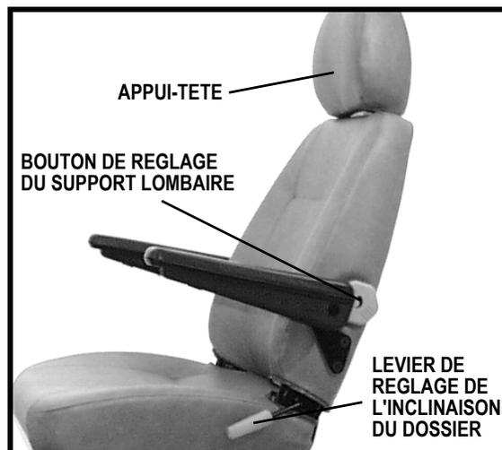
Figure 12. Réglages du siège et de l'appui-tête
