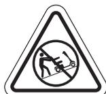
**Non posizionare la tuo scooter in modalità di sblocco ruote in pendenza.**
