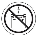
**Allontanare strumenti ed oggetti metallici dai terminale della batteria. Il contatto con attrezzi può provocare scosse elettriche.**
