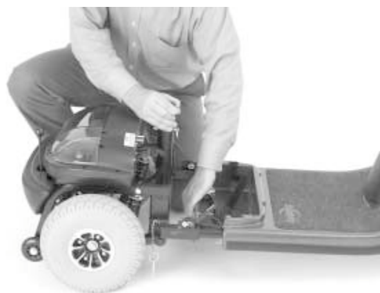
Figura 28. Separazione delle sezioni del telaio
