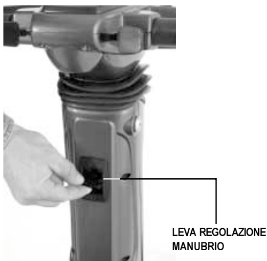
Figura 14. Regolazione Inclinazione del manubrio
