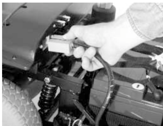
Figura 22. Disconnessione del morsetto fronte-retro
