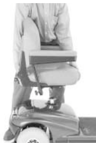
Figura 20. Rimozione del sedile
