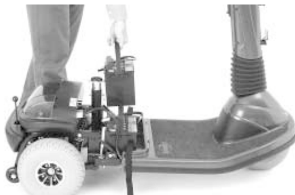
Figura 24. Rimozione delle batterie
