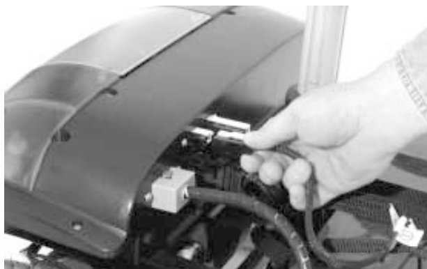
Figura 23. Disconnessione dei morsetti batterie
