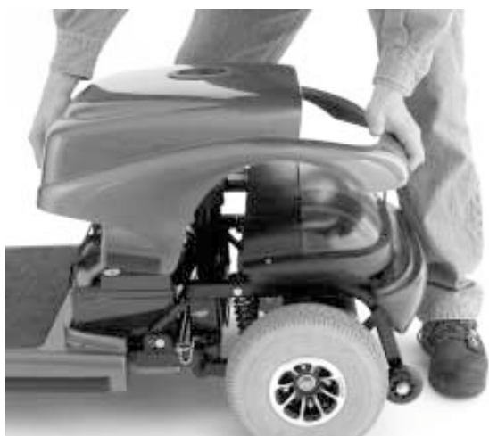
Figura 21. Rimozione del retroscudo
