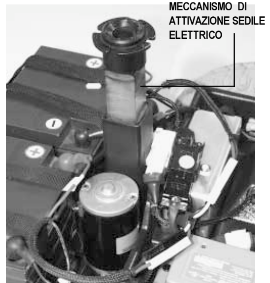
Figura 18. Meccanismo di attivazione sedile elettrico
