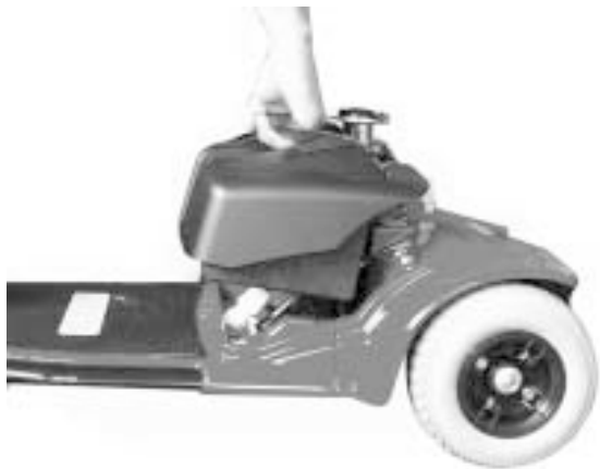
Figura 13. Estrazione del pacco batteria
