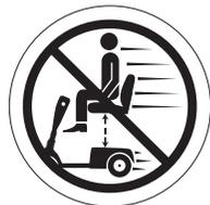
**No suba ni baje la torre del asiento con el scooter en movimiento.**
