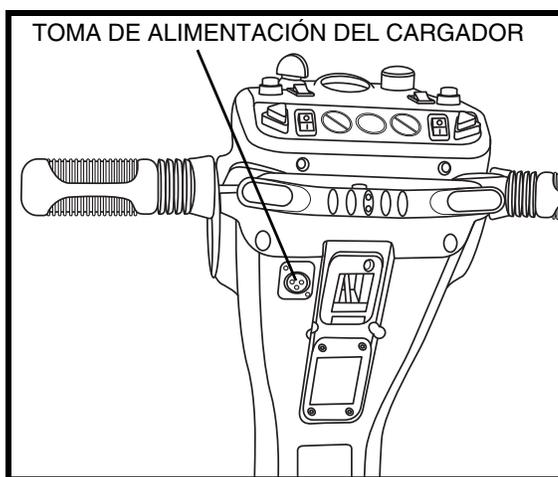
Figura 9. Toma de alimentación del cargador
