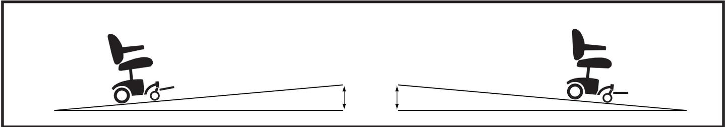
Bild 2. Maximal erlaubter schräge Winkel (Auffahrt und Abfahrt)
