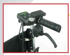
易于操作的控制器,带有调速盘, 电池显示灯和手控杆
