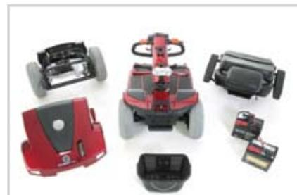
**Einfach demontiert in 7 Komponenten**
