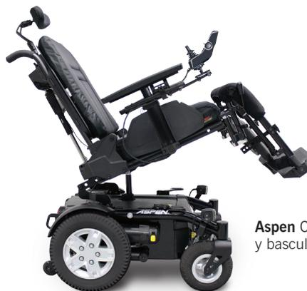
Aspen Con Q-logic TB Flex y basculación eléctrica
