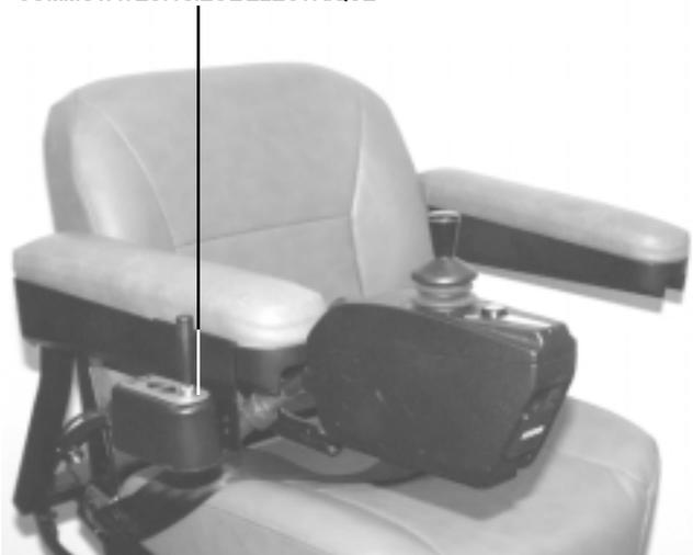
Figure 15. Commutateur Du Siège électrique
