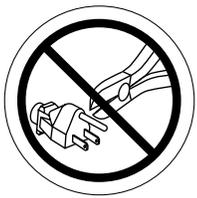
Il est dangereux d'enlever la fiche de mise à la terre de la prise électrique. Au besoin, faites installer une prise murale à 3 fentes ou utilisez un adaptateur à 3 fiches approuvé, sous peine de vous blesser ou de provoquer un accident avec dommages.
