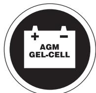
**N'utilisez que des batteries scellées "AGM" ou des batteries au gel afin de réduire les risques de fuite ou d'explosion.**
