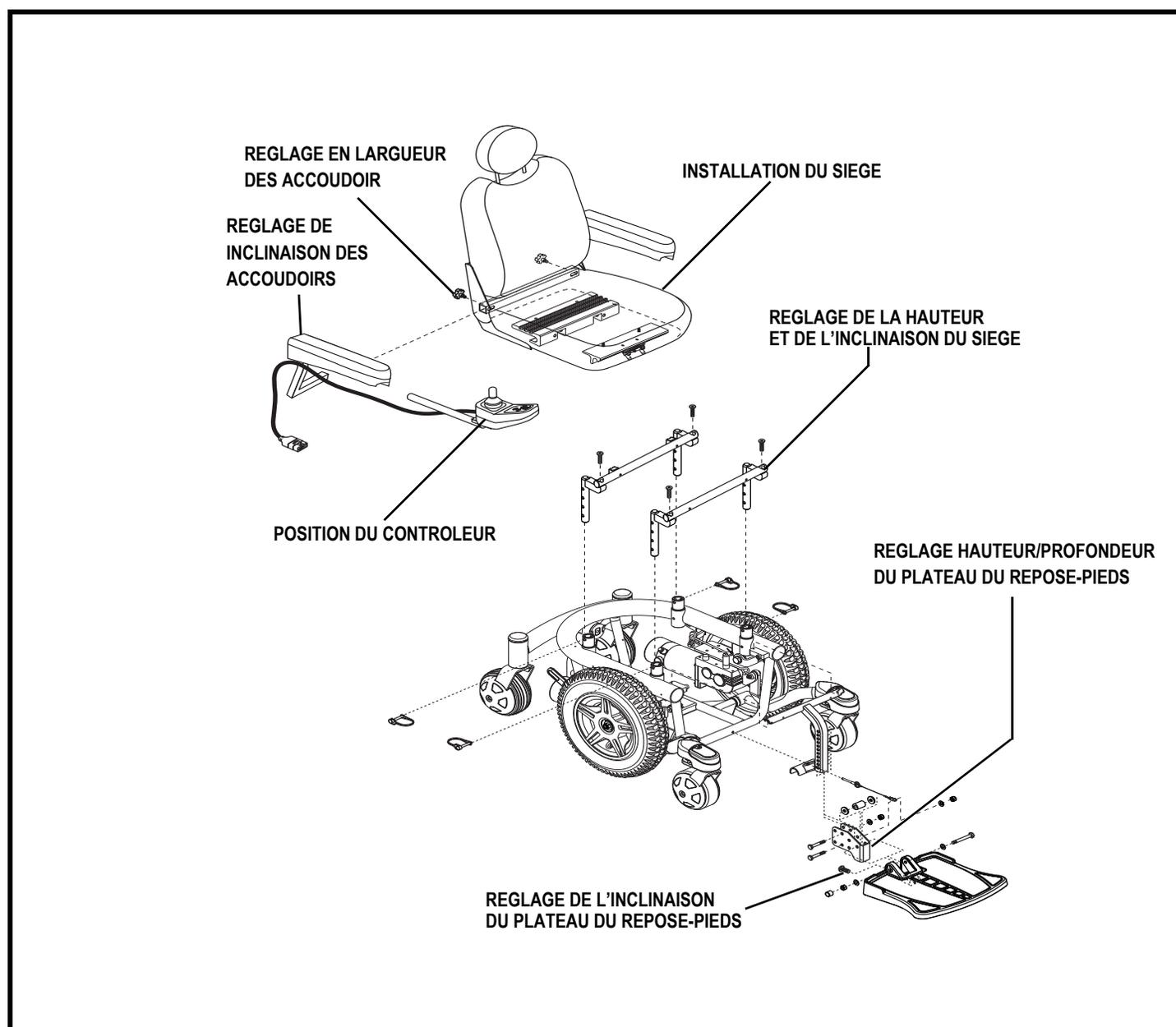
Figure 10. Vue de l'assemblage du fauteuil Jazzy 600 Serie (Système de siège standard montré)
