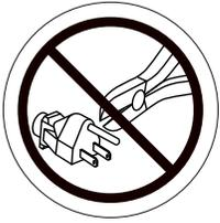
**Ne pas retirer la fiche de mise à la terre sous peine de provoquer un incendie. Seulement si absolument obligatoire, vous pouvez utiliser un adaptateur à trois fiches dans une prise électrique à deux fentes.**
