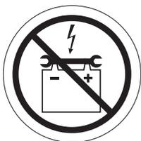
**Tenez les outils et autres objets en métal loin des bornes des batteries. Un contact avec un outil en métal peut provoquer un choc électrique.**
