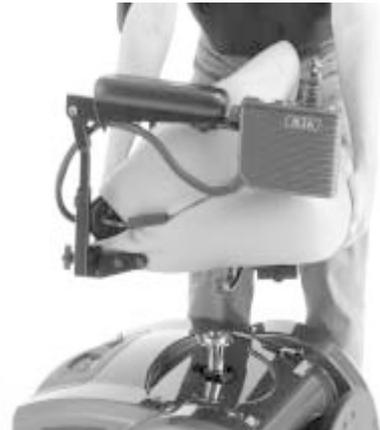
Figure 22. Enlèvement du siège
