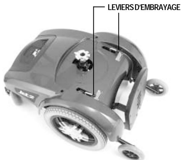
**Figure 5. Débrayé (neutre)**
