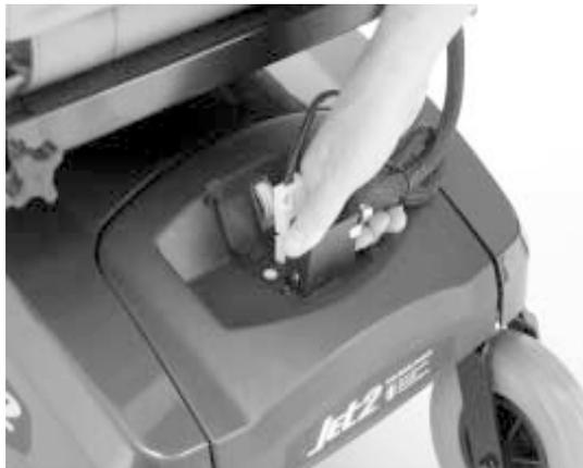
Figure 10. Connecteur 9-fiches du contrôleur
