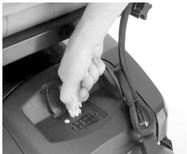
Figure 9. Connecteur du chargeur
