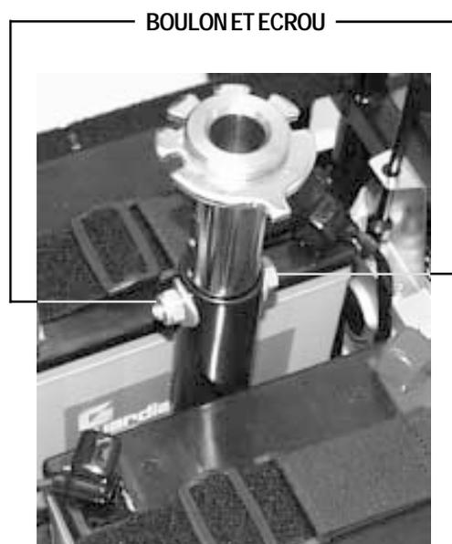
Figure 12. Boulon et écrou du mât du siège
