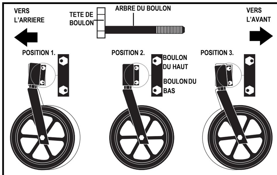
Figure 25. Réglage de l'angle des roues avant
