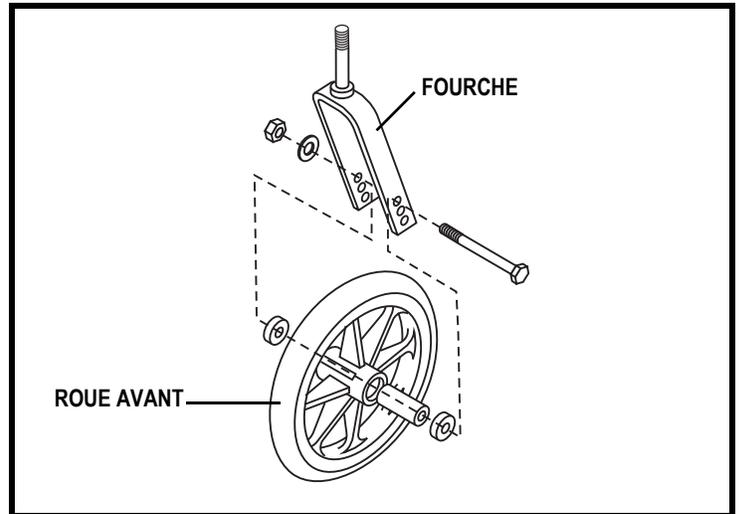
Figure 23. Position des roues avant
