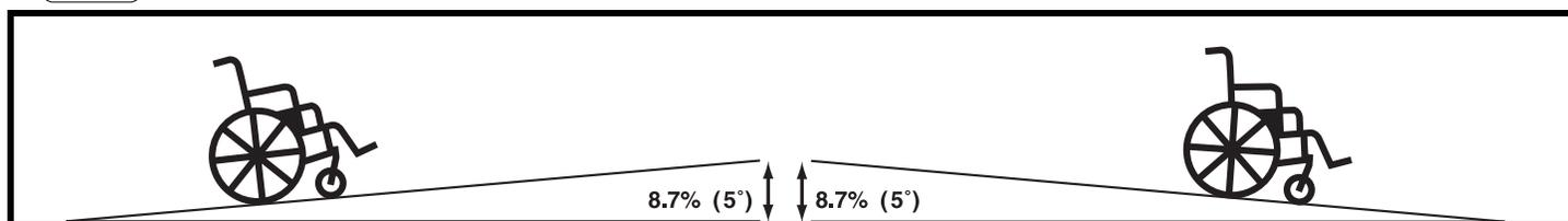
Figure 1. Inclinaison maximale (Montée ou descente)
