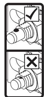
**S'assurer que les billes de verrouillage sur les essieux à dégagement rapide sont bien sur place et sont entièrement visibles après l'installation de la roue motrice.**
