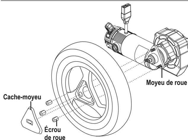
Figure 12. Roue motrice avec trois écrous de roue et cache-moyeu
