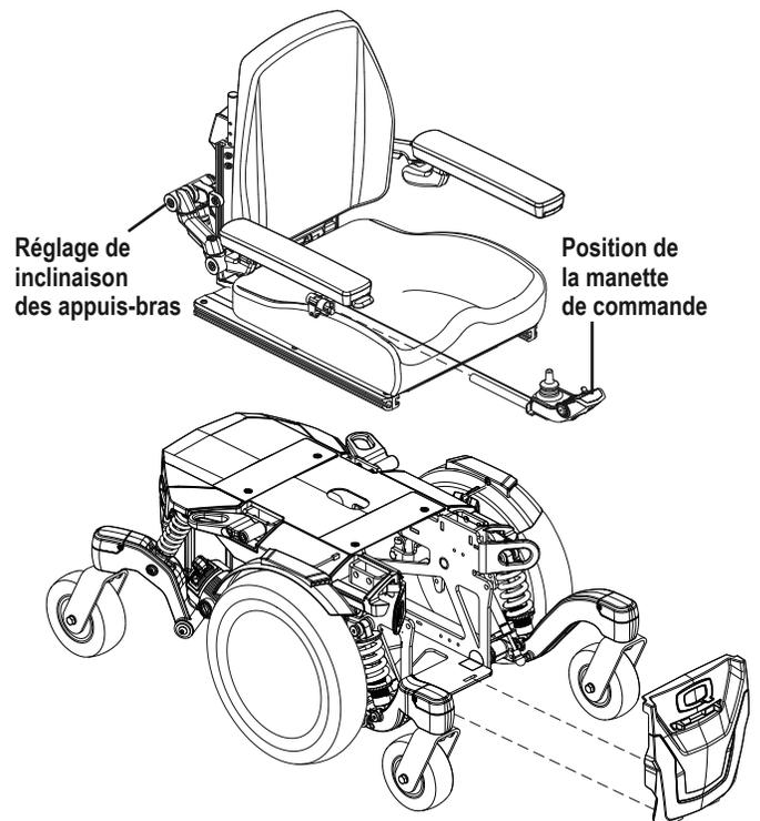
Figure 5. Vue de l'assemblage du fauteuil
