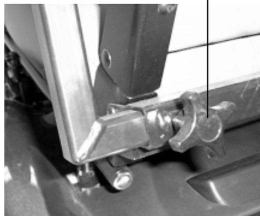
Figure 5. Réglage largeur appuis-bras
