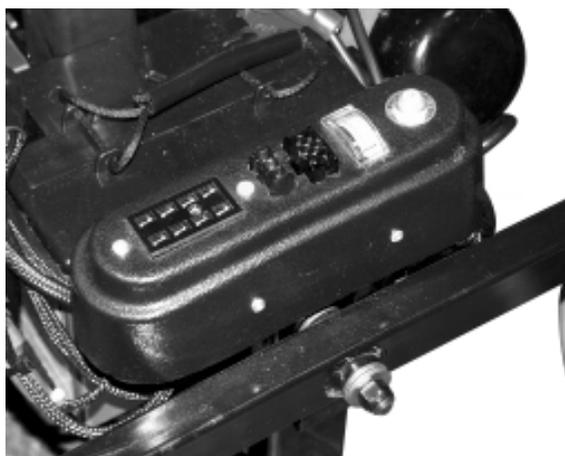
Figure 22. Boîtier Commutateur siège électrique
