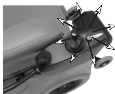
Figure 18. Manette de Contrôle "Pilot"
