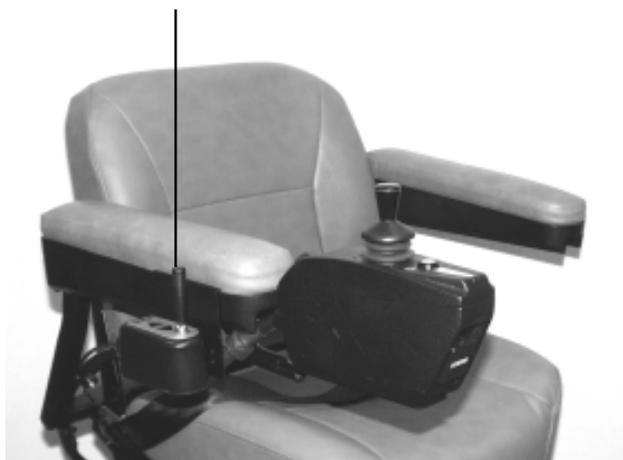
Figure 21. Commutateur du siège électrique
