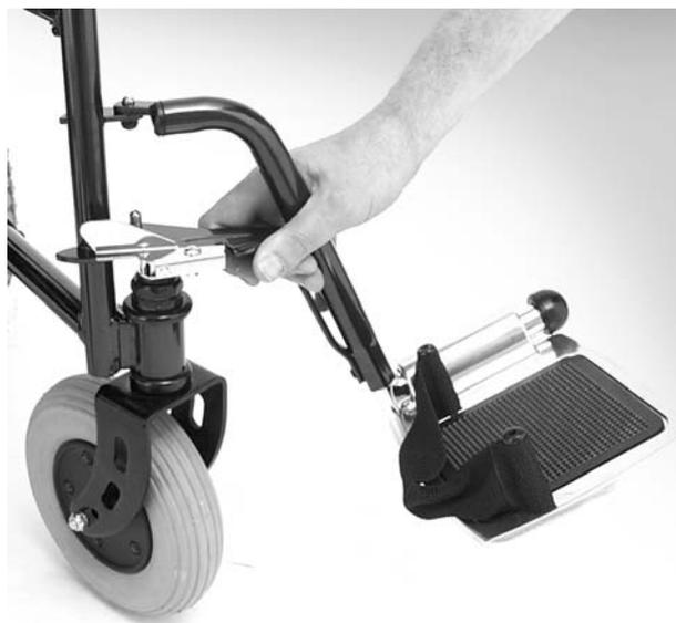
**Figure 8. Installation des repose-pieds**
