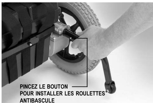
**Figure 9. Installation des roulettes antibasculé**
