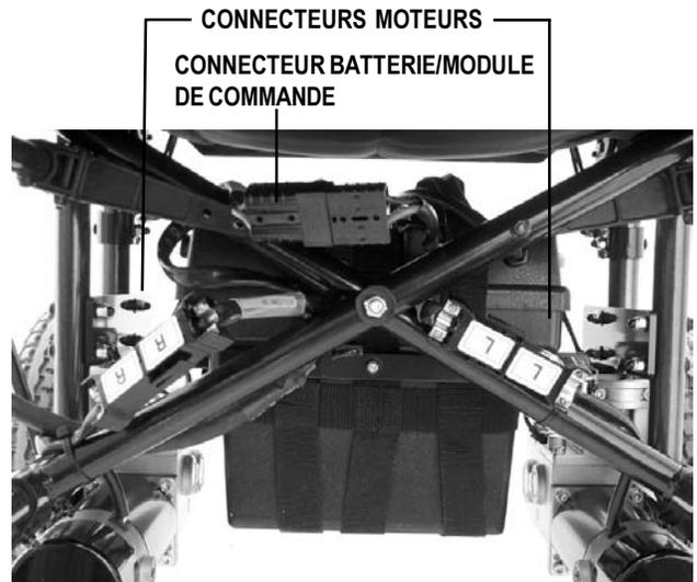
Figure 12. Branchements électriques avant
