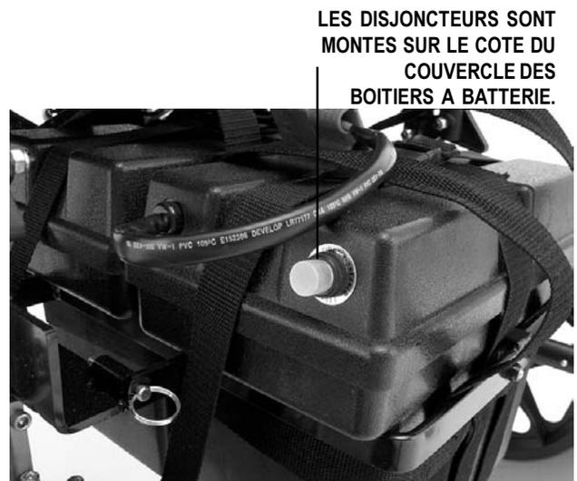
Figure 14. Disjoncteur arrière
