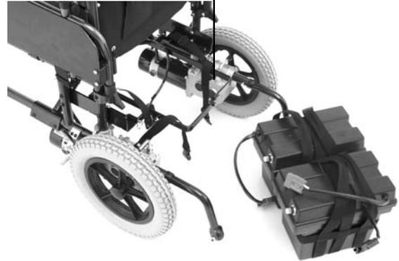
Figure 20. Jazzy 1113 - Boîtiers à batteries retirés
