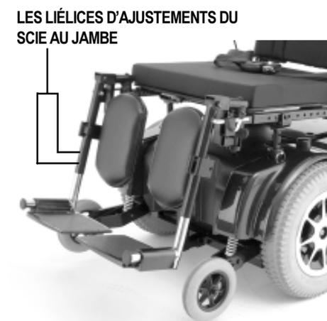
La Figure 25. Option D'élévation do Scie au Jambes
