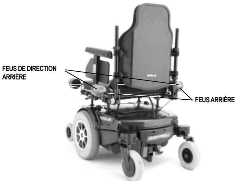
La Figure 9. L'Emballage Complet D'Éclairage (À L'Arrière)
