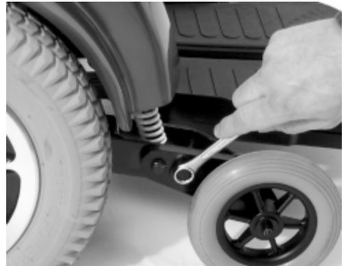
La Figure 28. Ajustement de Roue Contre-Renversement (Cam)
