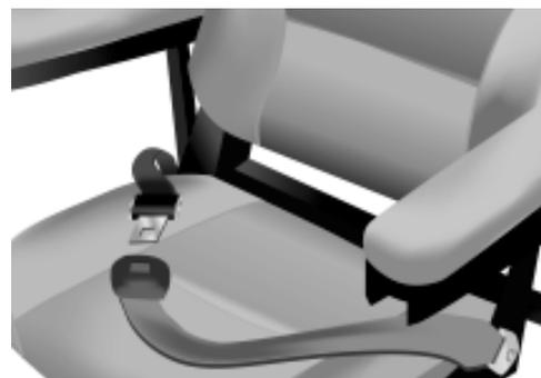
Figure 40. La ceinture de positionnement
