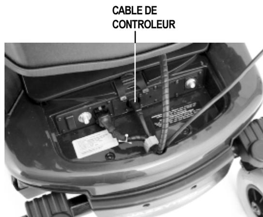
La Figure 11. Connecteur de Cable Contrôleur
