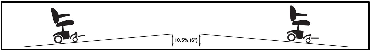
Figure 1. Montée/Descente maximale recommandé
