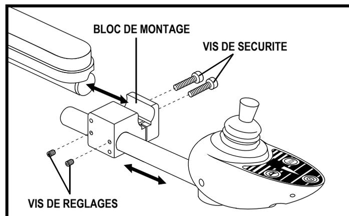
Figure 18. Support de montage de la manette de commande (Siège standard)
