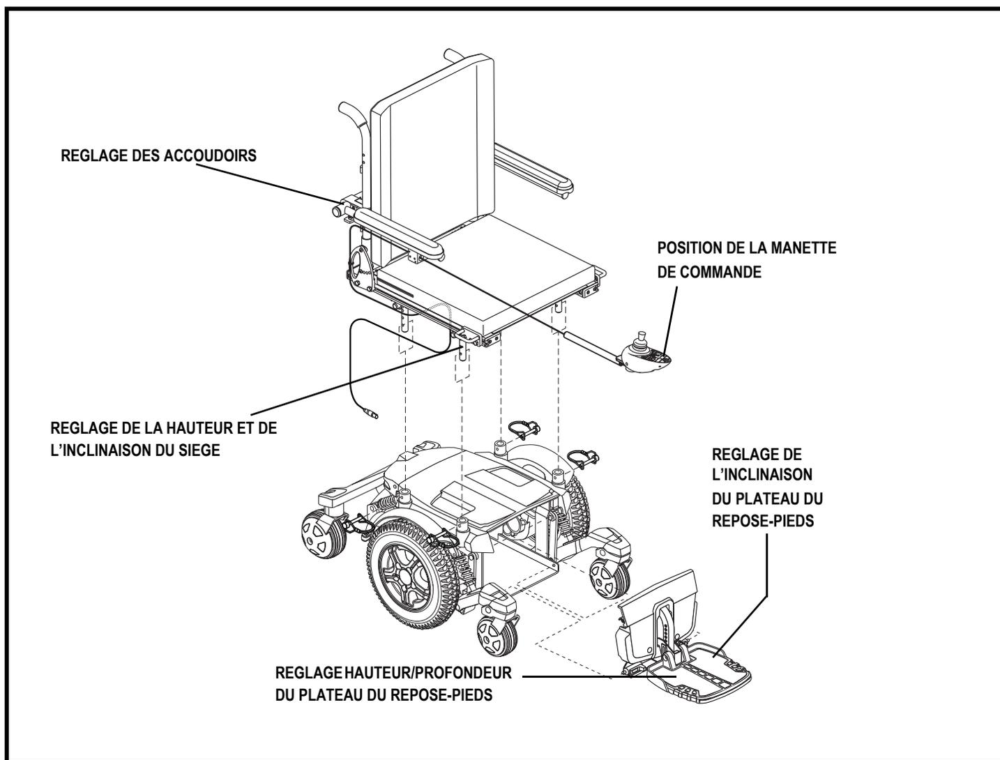
Figure 10. Vue de l'assemblage du fauteuil Quantum 6000 (Siège Synergy montré)
