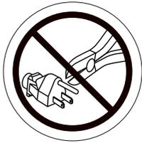
**Il est dangereux d'enlever la branche de mise à la terre de la prise électrique. Au besoin, faites installer une prise murale à 3 fentes ou utilisez un adaptateur à 3 branches approuvé.**
