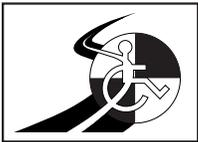
**Indique que le fauteuil motorisé, équipé d'un système de siège possédant des vignettes similaires, est conforme aux normes ANSI/RESNA WC/Vol. 4, Section 19 pour le transport de ce fauteuil occupé dans un véhicule moteur.**
