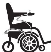
**Fixez le câble du contrôleur correctement afin d'éviter que celui-ci ne se prenne dans les roues, qu'il se coince entre le siège et la structure ou qu'il ne s'endommage dans le cadre d'une porte.**
