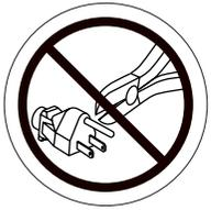
Il est dangereux d'enlever la branche de mise à la terre de la prise électrique. Au besoin, faites installer une prise murale à 3 fentes ou utilisez un adaptateur approuvé à 3 branches.
