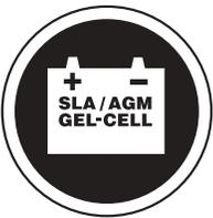
N'utilisez que des batteries scellées "AGM" ou des batteries au gel afin de réduire les risques de fuites ou d'explosions.
