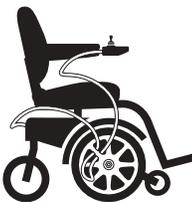
Fixez le câble du contrôleur correctement afin d'éviter que celui-ci ne se prenne dans les roues, qu'il soit coincé entre le siège et la structure ou qu'il soit endommagé par le cadre d'une porte.
