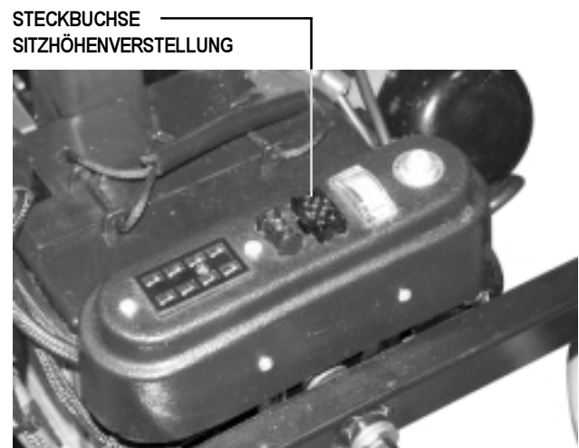
Abb. 18. Steckbuchse für den schalter der sitzhöhenverstellung
