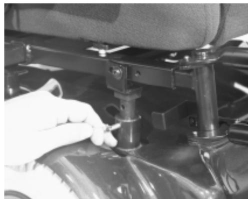
ABB.10. DEN BOLZEN AUS DEN SITZPFOSTEN HERAUSZIEHEN
