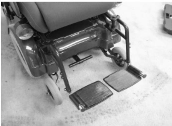
ABB. 28. ABSCHWENKBARE BEINSTÜTZEN
