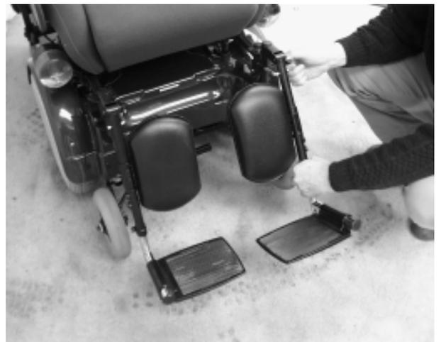
ABB. 27. HÖHENVERSTELLBARE BEINSTÜTZEN
