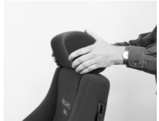
ABB. 11. EINSTELLUNG DER KOPFSTÜTZE
