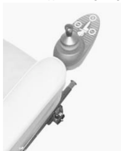
Zeichnung 19. Beweglicher Steuerknueppel (Vorwaerts Position)
