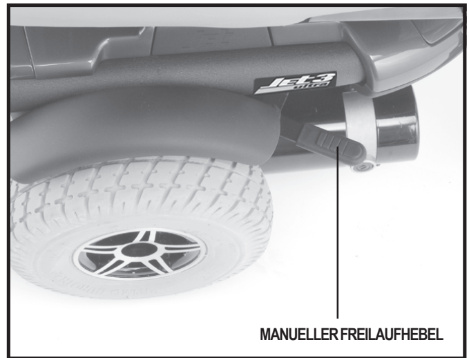
Abb. 9. Freilaufmodus (Antrieb deaktiviert)
